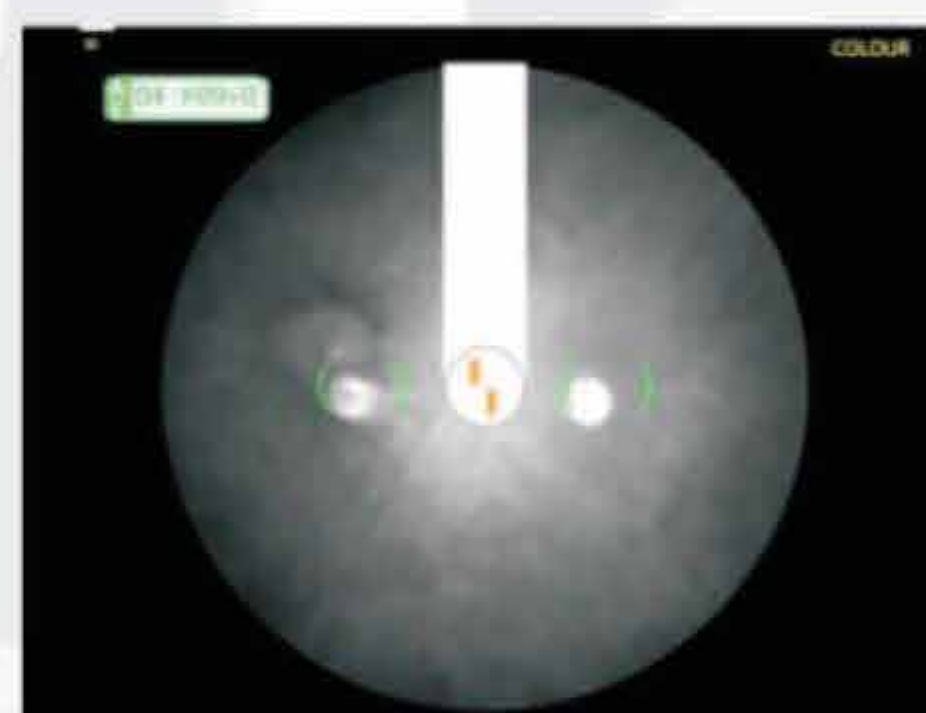
Línea dividida desalineada
